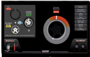
Lastik çekmesini gerçek yol şartlarında tespit eder ve lastikleri çekmeyecek şekilde araca sıralayarak yerleştirir.
