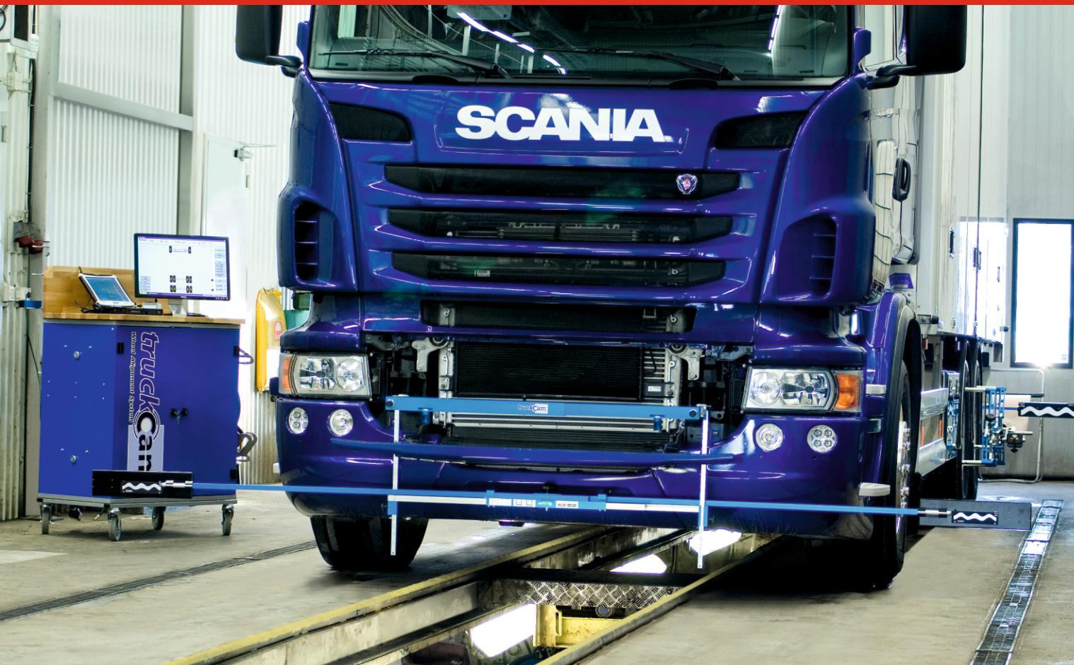
Dünyanın en hızlı 3 boyutlu kamera sistemiyle rot ayar ve dingil kaçıklığını ölçen ve raporlayan sistemidir.
